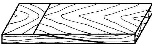
FIG. 24 SCARF JOINT
