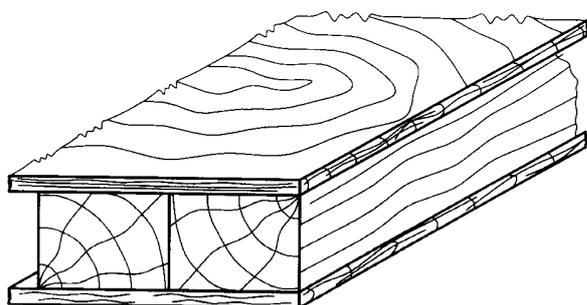
FIG. 11 BATTEN BOARD
