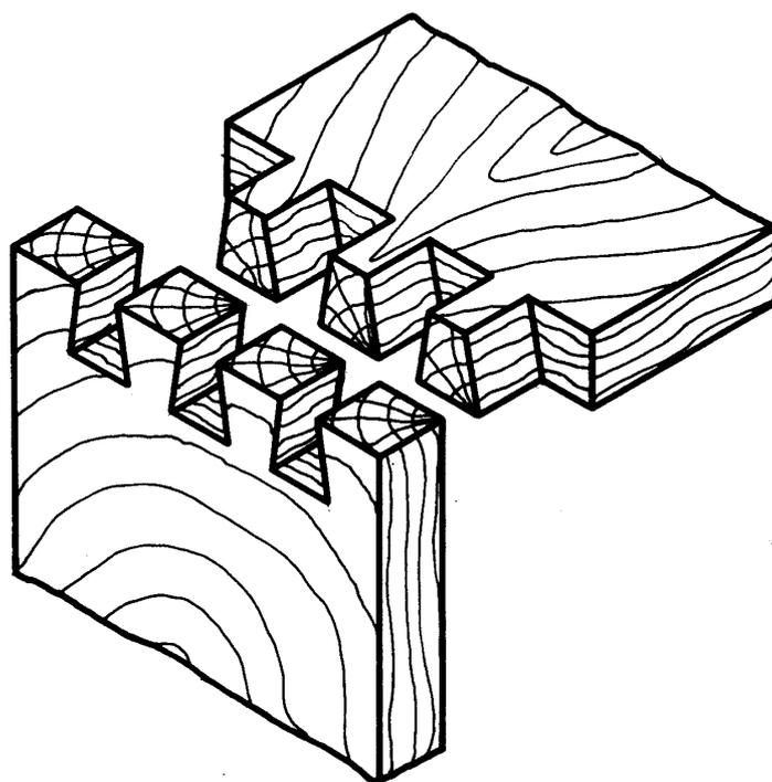
FIG. 19 DOVETAIL JOINT
