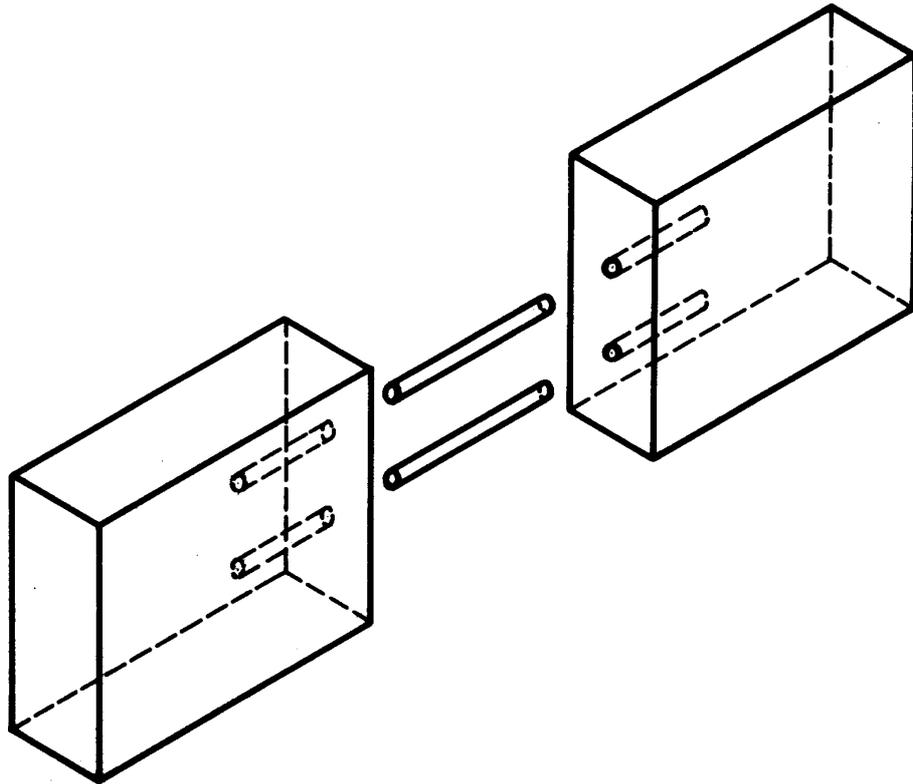
FIG. 20 DOWEL JOINT
