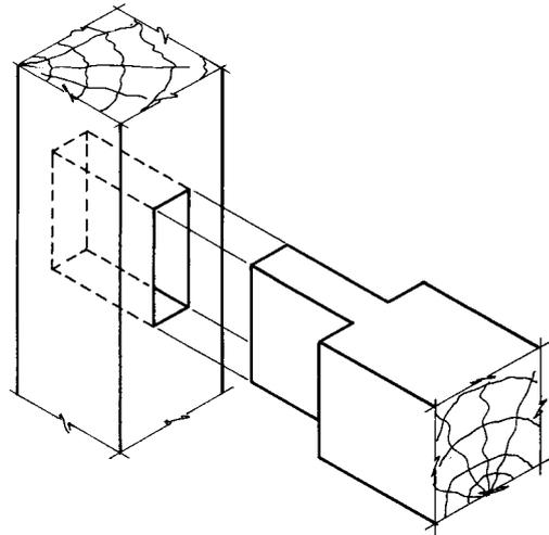
FIG. 25 MORTISE AND TENON JOINT
